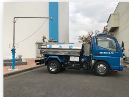
緊急時給水栓と給水車
