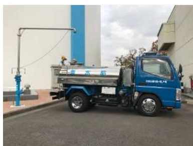
写真 7 緊急時給水栓と給水車
