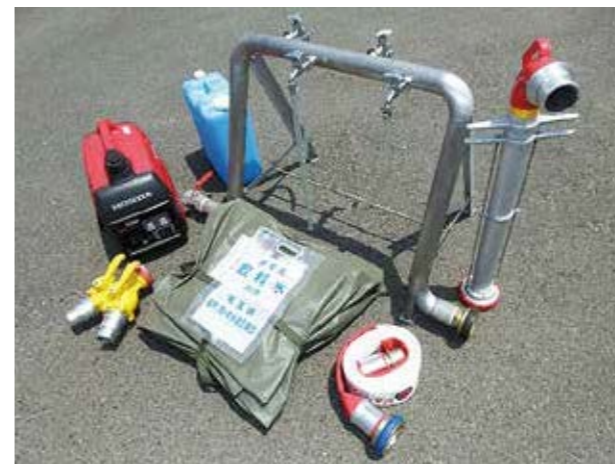
仮設給水栓等災害用備蓄品
