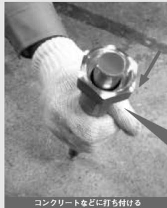
穿孔機をバルブから取り外してください。次に穿孔機本体をしっかり支え、切片押し棒をコンクリートなどの硬い場所に打ち付けるか、ハンマーで叩き、穿孔片を取り除いてください。
