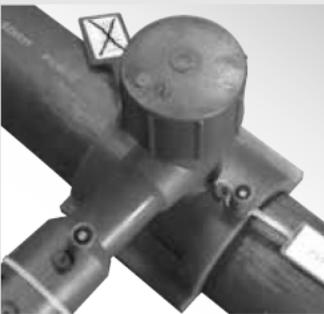
管の融着面をスクレープ、継手を含め清掃後、クランプして融着してください。融着後インジケータ隆起の確認をし、所定時間冷却してください。(通電終了後5分以上クランプで固定) 次に、給水管側を接続してください。サドル～給水管～第一止水栓をテストする場合は、30分以上経過後に行ってください。
